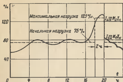
Рис. 3-2. Преобразование реального графика нагрузки в эквивалентный.
